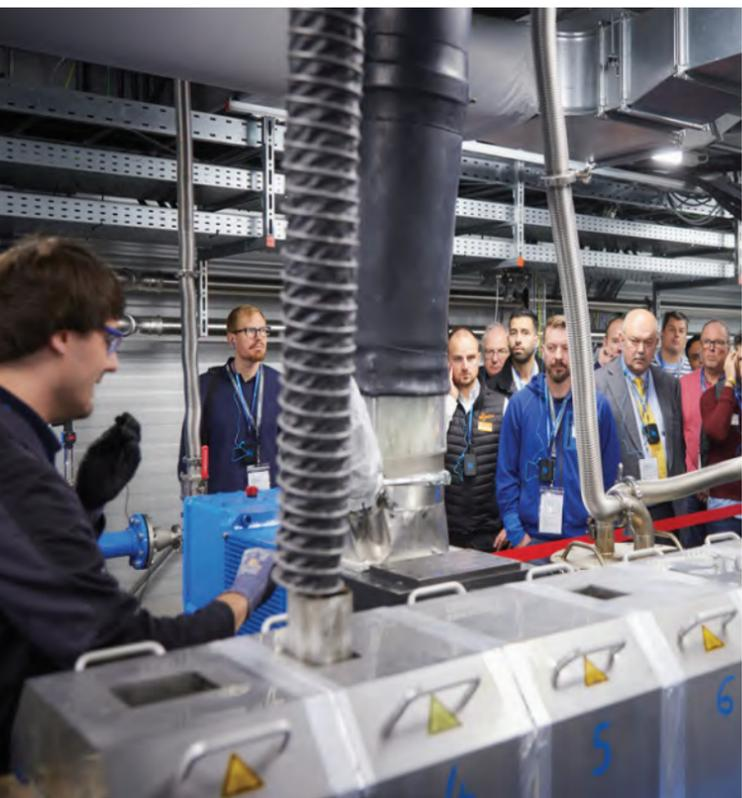
de la superficie provocada por la rotación de los dos tornillos produce una capacidad de desvolatilización especialmente alta en este tipo de extrusora.
