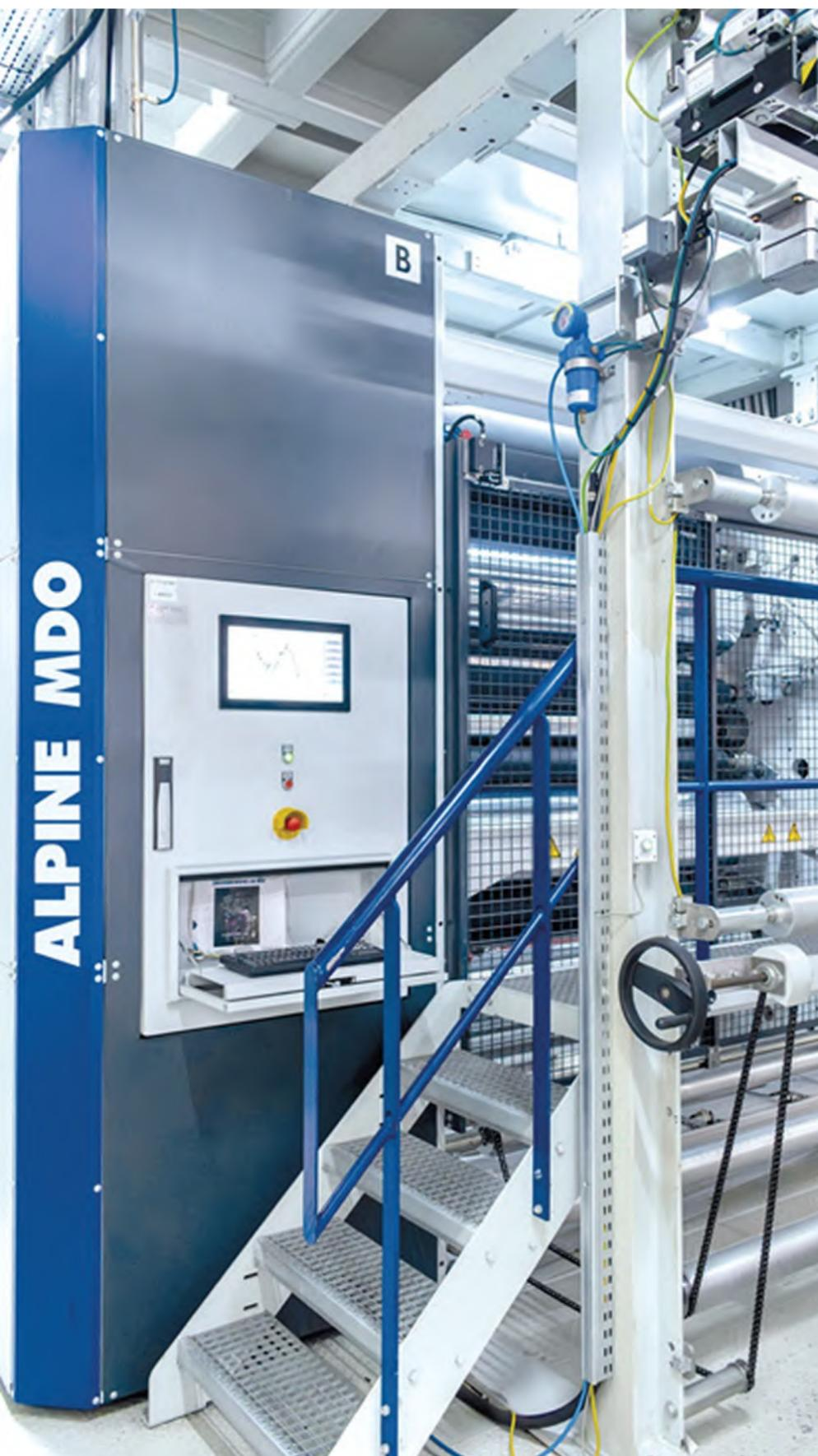
• La MDO en línea es la pieza central de la línea de film soplado de Microplast Coldeplast. El estirado monoaxial del film soplado mejora las propiedades del film y reduce el material de empaque que reduce los costos del film.
